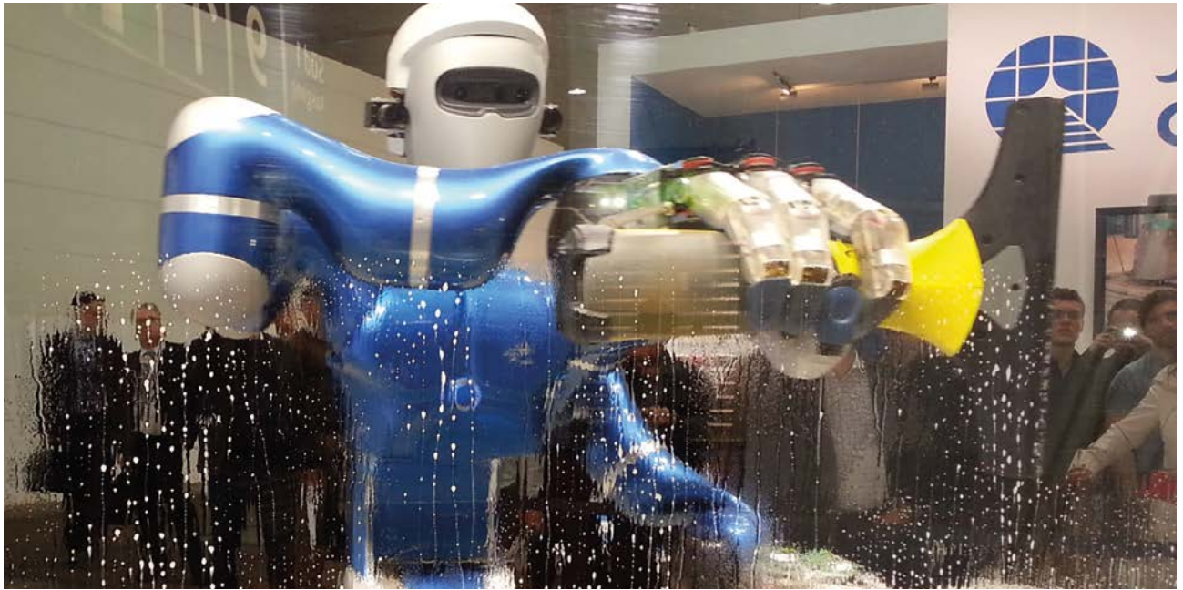
Der 1,91 m große humanoide Roboter Rollin' Justin heute noch beim Putzen, morgen schon soll er Astronautinnen und Astronauten im Weltraum assistieren. 2008 wurde das ca. 200 Kilo Schwergewicht der Öffentlichkeit vorgestellt.
