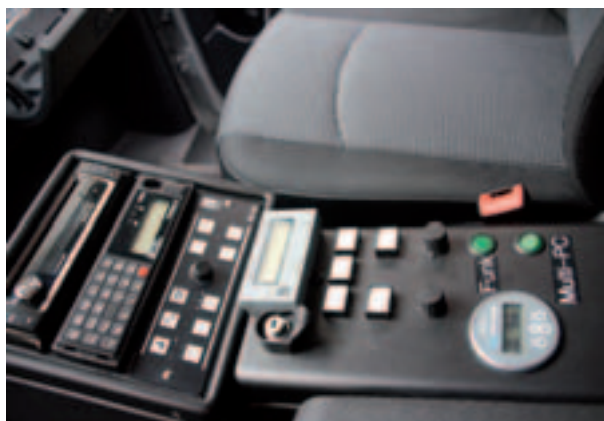
Der interaktive Funkstreifenwagen aus Brandenburg stand im Mittelpunkt des Interesses der Teilnehmer. Unten links: Display für Aufträge, Navigation und Kamera, rechts: Multi-PC Fotos: Piesch
